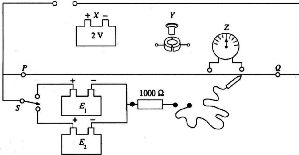
කෝෂ දෙකක වී. ගා. බ.  $E_1$  සහ  $E_2$  සන්සංදනය කිරීම සඳහා භාවිත කෙරෙන විභවමාන සැකැස්මක අසම්පූර්ණ පරීක්ෂණාත්මක ඇටවුමක් රූප සටහනේ පෙන්වා ඇත.  $PQ$  යනු දිග 1 m සහ ප්‍රතිරෝධය  $20 \Omega$  වූ කම්බියකි.  $X, Y$  සහ  $Z$  මගින් පිළිවෙලින් නිරූපණය කරන්නේ 2 V ඇකියුම්ලේටරයක්, සුවිච්චියක් සහ මැද බිංදු ගැල්වනෝමීටරයකි.  $S$  යනු දෙමං යතුරකි.
